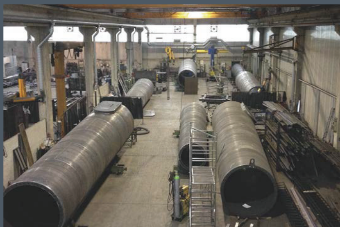
Carpenteria per realizzazione torri eoliche alte da 36 a 42 metri.
